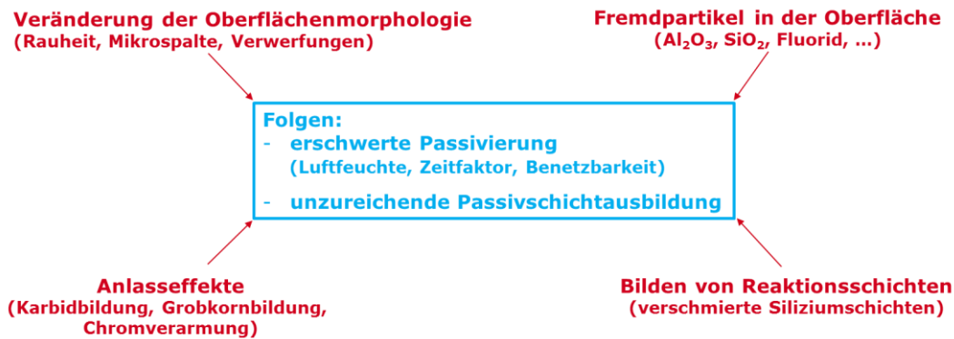
Abb. 38: Mögliche Ursachen für eine erhöhte Korrosionsanfälligkeit nach einer Schleifbearbeitung
