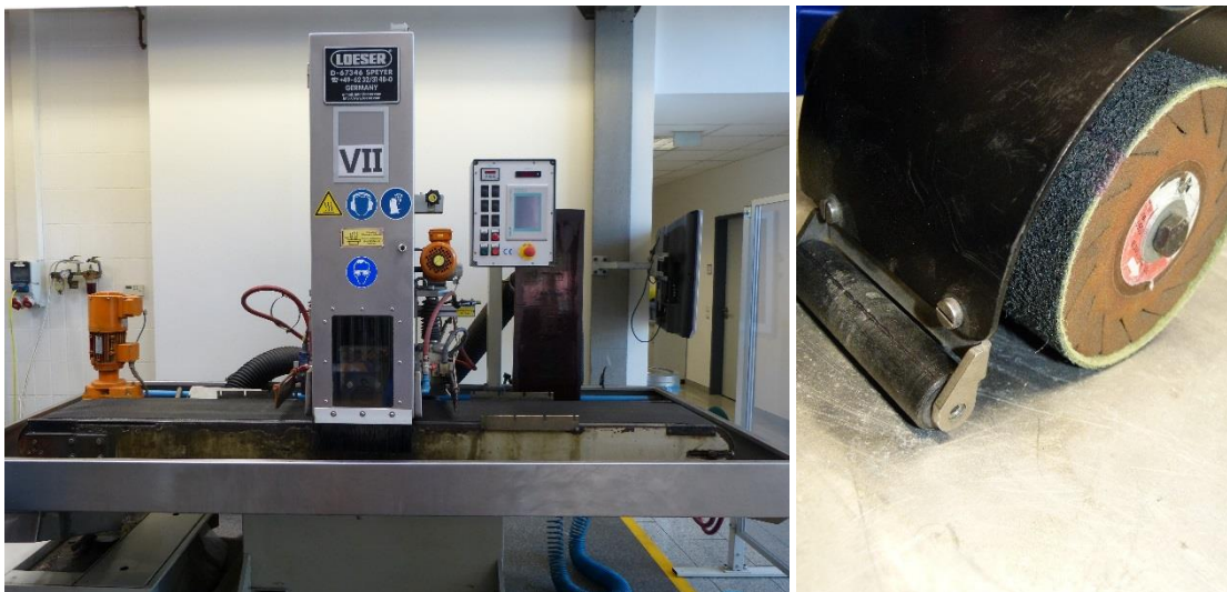
Abb. 3: Flachsleifmaschine bei VSM (links) und Handschleifmaschine mit Schleifvlies (rechts)
